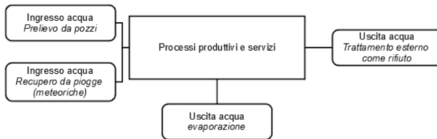
Figura 19 - schema bilancio idrico dello stabilimento di Badia al Pino
