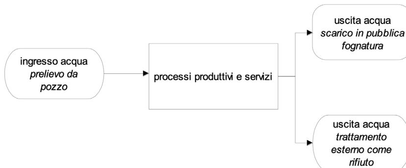
Figura 20 – schema ciclo delle acque stabilimento di Viciomaggio
