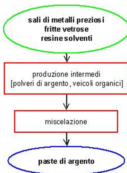
Figura 15 – Schema semplificato processo produzione catalizzatori - sito Vicomaggio
